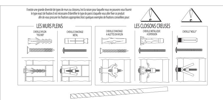
Utiliser une taille de forêt adaptée à la quincaillerie utilisée et au type de mur.
